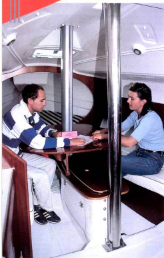
Le pont injecté donne à l'intérieur un aspect bien fini et lisse. On remarquera que les ampoules et le passage des fils électriques étaient prévus dans le moule de pont.
